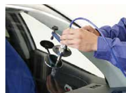
飛び石等の小さなひび割れをプロの特殊技術で目立たなく、かつひびの伸長を応急的に防ぎます。
